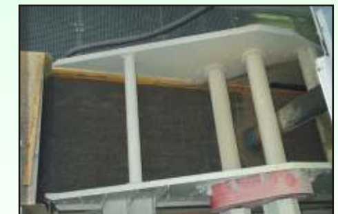
Linear Entwässerungssieb LESF 15/50-1 Entwässern von Sand 0-4mm mit Aufgabe von Zyklonausrag.
