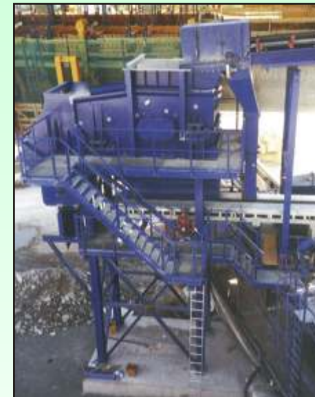
Ellipsenschwerlastsieb ESLS 15/40-2 mit Stufenrost im Oberdeck und Lochblechbelag im Unterdeck Absiebung 0-500mm.
