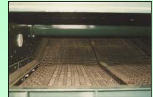
Quergespannte Gummibeläge zur Absiebung von siebschwierigen Materialien
