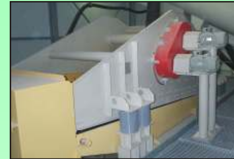
Linear Entwässerungssieb LESF 15/50-1 Entwässern von Sand 0- 4mm.
