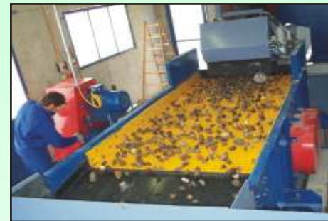
Ellipsenschwingsieb EFKHS 14/30-2 Absiebung von Kies.
