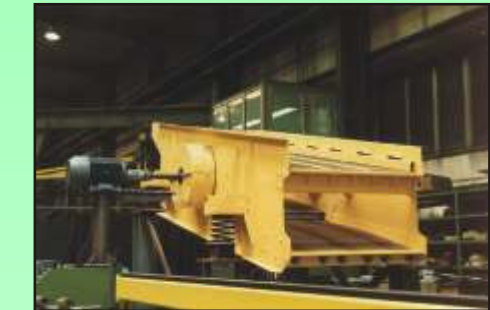
Kreisschwinger KGS 12,5/30-2, Bauschutt, Absiebung 56mm und 32mm.
