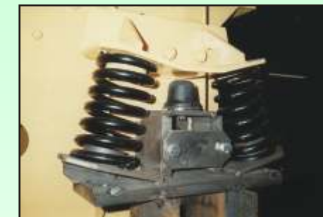
Hohe Stabilität durch schräge Schraubendruckfedern, Anschlagpuffer bei Stoßbelastungen, Ausschlagdämpfer für die Begrenzung des Auslaufausschlages.
