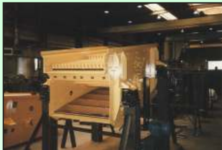
Kreisschwinger KSLS 12/23-2 für fahrbare Anlage, Aufgabe Bauschutt 0-1000mm.
