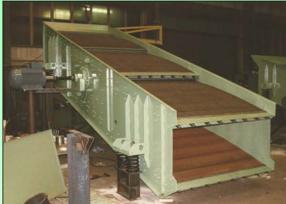
Kreisschwinger KFK 20/60-2, Kalkstein, Splittabsiebung 8 mm und 5 mm.
