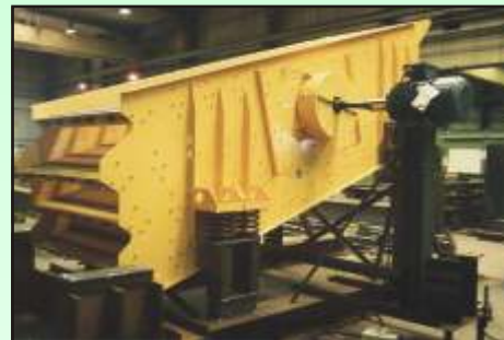
Kreisschwinger KGK 16/40-3,5, Absiebung Kalkstein 32mm, 16mm, 8mm und 4mm.
