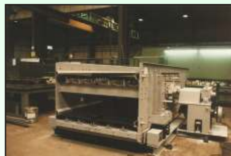
Ellipsensieb, EGKH 18/40-2, Absiebung Kalkstein 75mm und 25mm, beide Stufen mit quergespannten Gummibelägen.
