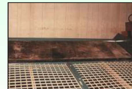
Aufgabetraverse mit Gummiaufschlagplatte, Siebbeläge mit Gummiklemmleisten und Kunststoffkeilen befestigt.
