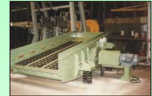
Kreisschwinger KGS 12,5/25-1, Aufgabe Kalkstein 0-400mm, Absiebung 90mm.
