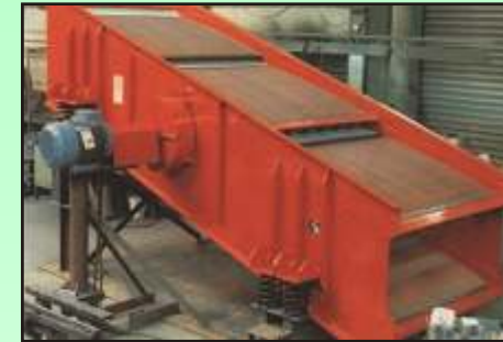
Kreisschwinger KKG 18/50-2, Kalksteinabsiebung 8mm und 4mm.
