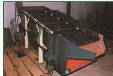
Kreisschwinger KGK 16/40-2, Kiesabsiebung 16mm und 2mm, mit Kunststoff-Stecksiebbelägen sowie Spritzwasservorrichtung.
