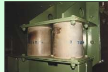
Schwingungsisolierung durch Gummipuffer, hohe Stabilität bei Stoßbelastungen.
