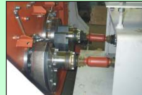
Wartungsfreie Gelenkwelle, auf Lebensdauer geschmiert.
