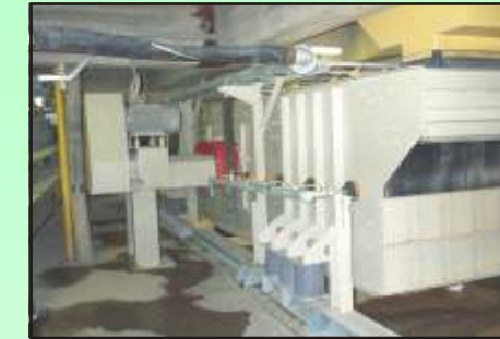
Ellipsenschwingsieb EGKHS 18/60-2,5 Absiebung von Kies.
