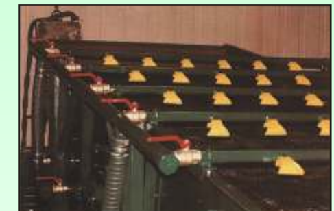
Spritzwasservorrichtung mit einzeln einstellbaren Spritzdüsen. Einzelne Spritzrohre abschließbar, Spritzrohre elastisch gelagert.
