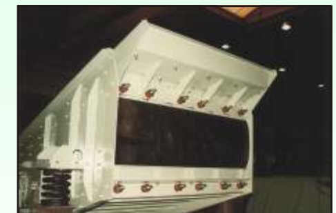
Gummivorhang als Abdichtung (Staub bzw. Wasser) zwischen den Stufen. Aufgabetraverse. Automatische Vorspannung der Siebbeläge.
