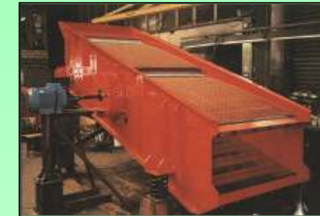
Kreisschwinger KKG 16/40-2, Kalkstein, Absiebung 22mm und 16mm.
