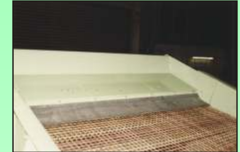
Aufgabetraverse zur Verteilung des Materials und Schonung der Siebbeläge. Aufschlagplatte auswechselbar. Stahl oder Gummi.
