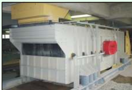
Ellipsenschwingsieb EGKHS 18/60-2,5 Absiebung von Kies.
