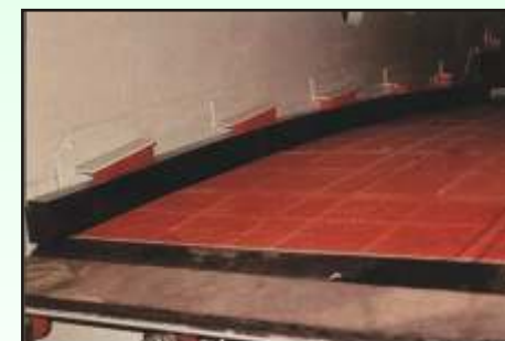
Kunststoffbeläge seitlich durch Keilleisten und Kunststoffkeile befestigt. Abdeckleiste für Spannelemente. Automatische Vorspannung.
