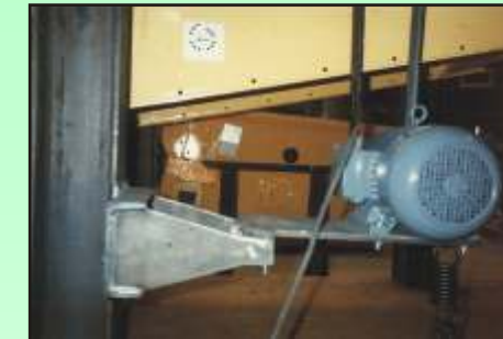
Abgefederte Motorplatte bei Riemenantrieben.
