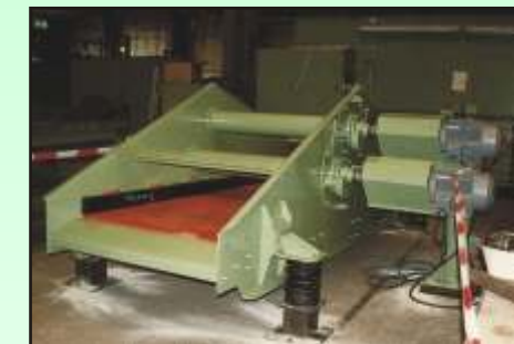
Vorbrechanlage für 1000t/h Kalkstein, 60cbm Bunker,hydr.Schubwagen SWH 17,5/50, Ellipsenschwingsieb ESLS 18/60-2, Backenbrecher DKB 1500x1200
