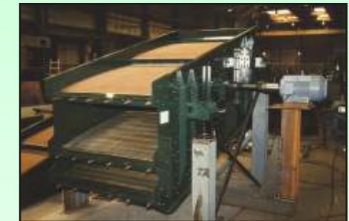
Kreisschwinger KKG 12,5/30-3, Diabas, Absiebung 8mm, 5mm und 3 mm.
