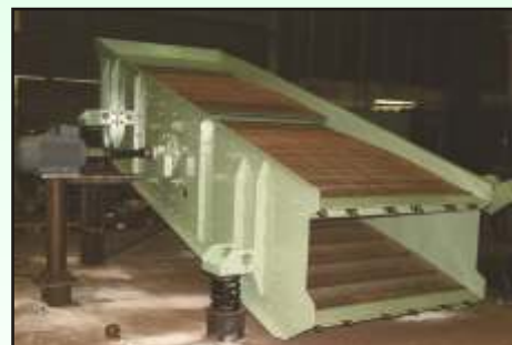
Kreisschwinger KGK 16/40-2 Maschenweiten 32mm und 16mm.
